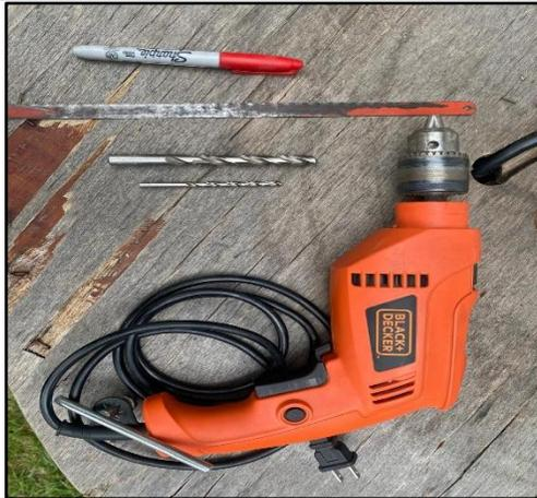
**Figura 1.** Taladro con dos brocas de diferentes diámetros, segueta y marcador.
