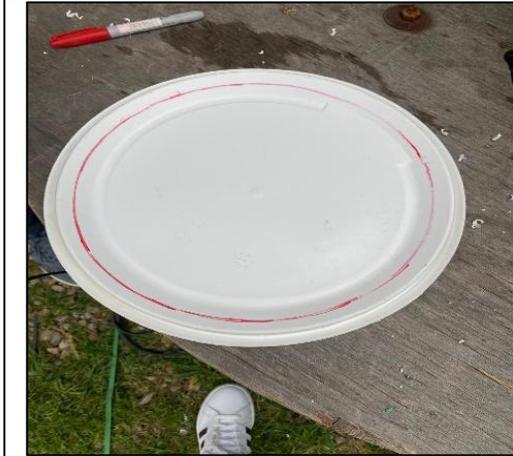
**Figura 9.** Se debe delimitar con un marcador la parte inferior del balde en las tapas de los baldes.
