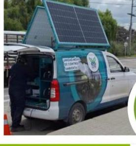
Se realizará la medición de gases a los vehículos de gasolina, ACPM y motos.
