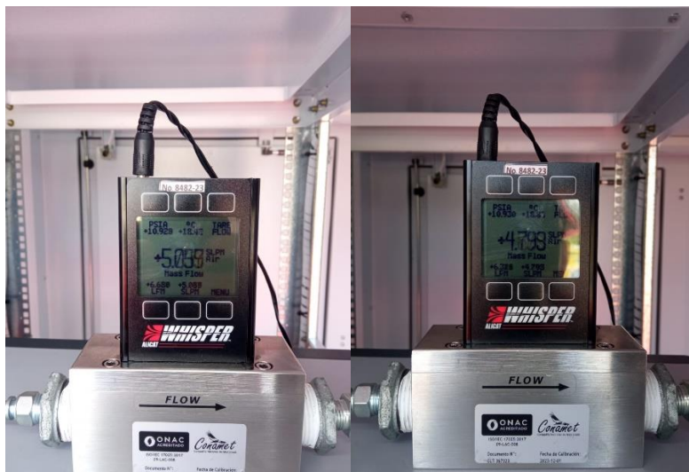
Ilustración 17. A la izquierda el valor del flujo entregado por el calibrador, a la derecha el valor del flujo una vez ajustado.
