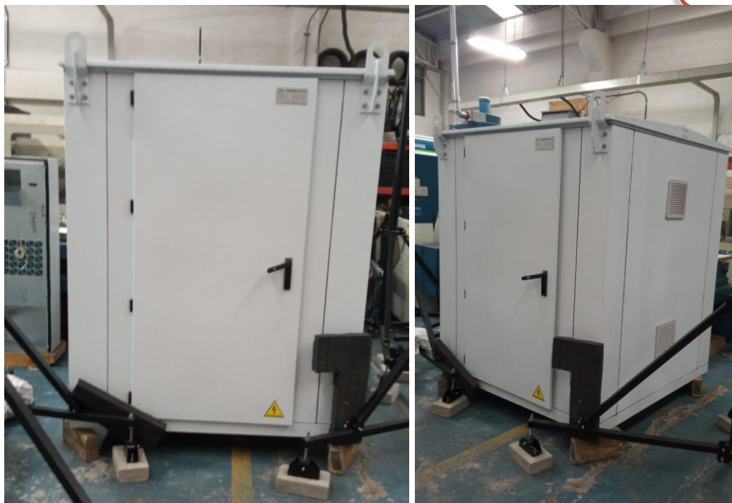
Ilustración 7. Ensamble de la Cabina tipo Shelter.
