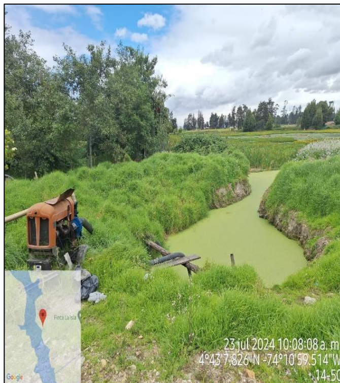
Ilustración 5. Motobomba en funcionamiento.
