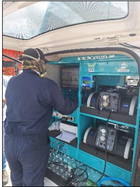
Ilustración No. 2. Unidad móvil de control ambiental
