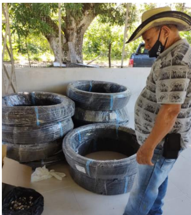
Llegada de materiales – manguera PF.
