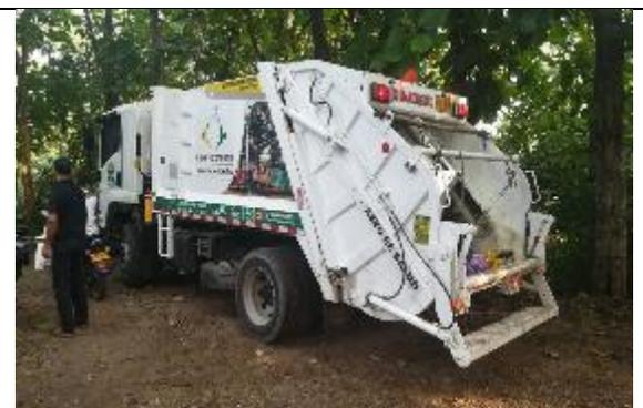
**Fotografía 6.** El camión recolector es de una capacidad máxima de 12 yardas cúbicas. Fuente: UATMA, 2019.
